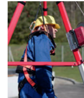
Aufrechte Körperhaltung beim Retten (Verwendung eines Sling-Sets)
